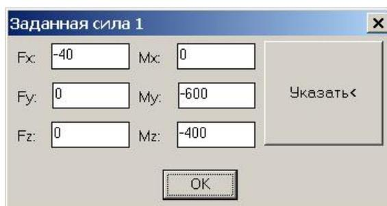
Рис. 3. Ввод проекций и моментов известных сил
